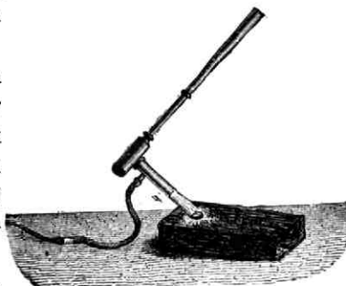
Fig. 37. Ontleding van loodoxyde op een stuk houtskool met de blaaspijpvlam.
