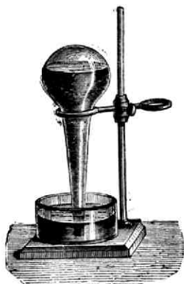
Fig. 42. Ontstaan van zuurstof in chloorwater.
