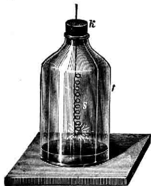
Fig. 13. Verbranding van ijzer in zuurstof.
