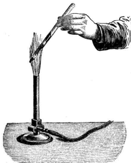
Fig. 38. Ontleding van rattenkruit door middel van houtskool.
