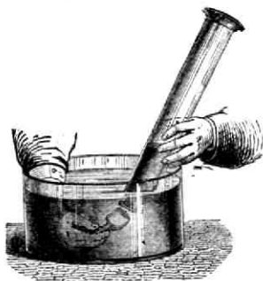
Fig. 21. Absorbtie van zwaveloxyde door water.
