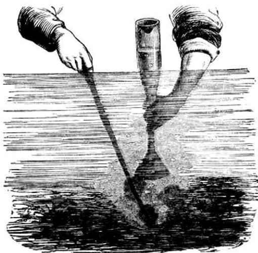
Fig. 70. Verzamelen van moerasgas.
