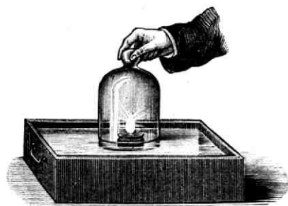
Fig. 9. Verbranding van phosphor in eene afgesloten ruimte.
