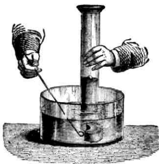
Fig. 41. Bereiding van waterstof uit water, door middel van natrium.
