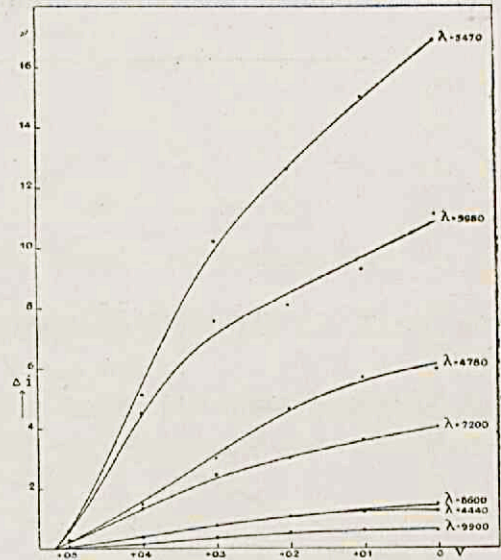
Fig. 9. Photoelektrische Charakteristik für verschiedene Wellenlängen. CuO in Zn(NO_3)_2 -Lösung.
