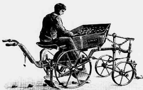
Fig. 28. Aardappelpootmachine van A. Bajac te Liancourt (Oise). Het stel kan ook als paardehak, als aanaardploeg en als aardappelrooier worden ingericht.
