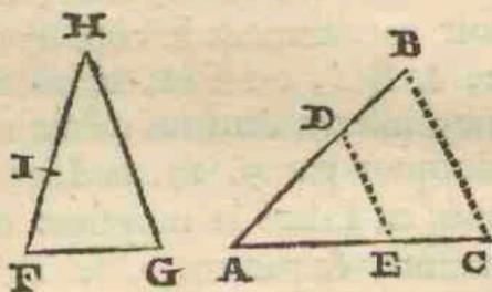
tion, dont le centre est A. Que les points B, C, soient chacun le point 6, & les points D, E, chacun le point 10. Appliquez la Ligne donnée FG sur la Ligne des Polygones de part & d'autre, de D en E, en sorte que la distance DE, de 10 à 10, soit égale à la base donnée FG: & le Compas de proportion demeurant ainsi ouvert, prenez la distance BC, de 6 à 6, pour avoir le côté FH, ou GH du Triangle qu'on cherche.
