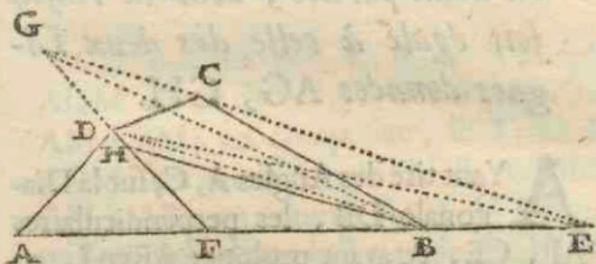
Trapeze ABCD, ce Triangle FBH est la moitié du Triangle FBG, ou du Trapeze FBCD, & par conséquent le tiers du Trapeze ABCD. D'où il suit que le Trapeze proposé ABCD, est divisé en trois parties égales, par les deux Lignes DF, BH. Ce qu'il falloit faire & démontrer.
