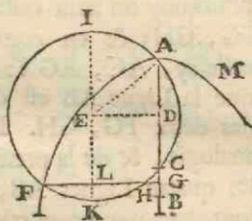
la Parabole, tirez la droite  $FG$ , perpendiculaire à l'axe  $AC$ ; & les deux Lignes  $AG$ ,  $FG$ , seront les deux Moyennes qu'on cherche: de sorte que les quatre Lignes  $AB$ ,  $AG$ ,  $FG$ ,  $AC$ , seront dans une continuelle proportion.
