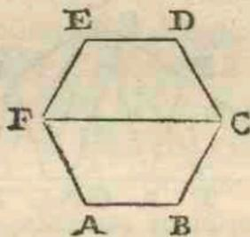
lement par une Ligne parallele au côté donné AB, on tirera cette Ligne par les deux Angles F, C, qui sont diametralement opposez & également éloignez du côté donné AB. La démonstration en est trop claire pour en parler icy davantage.
