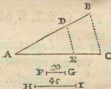
dont le centre est A: que les points B, C, soient chacun le 45<sup>e</sup> Plan, & les points D, E, chacun le 20<sup>e</sup> Plan. Appliquez la longueur de la plus grande Ligne donnée HI, sur la Ligne des Plans de part & d'autre aux points B, C, en sorte que la distance BC, de 45 à 45, soit égale à la plus grande Ligne donnée HI; & alors la distance DE, de 20 à 20, sera moyenne proportionnelle entre les deux Lignes données FG, HI.
