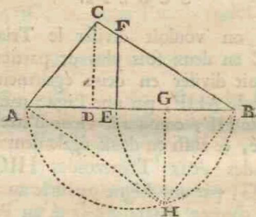
AB, & le segment BD terminé par la perpendiculaire CD, tirez du point E, au côté AC, la perpendiculaire EF, qui divisera en deux également le Triangle proposé ABC.
