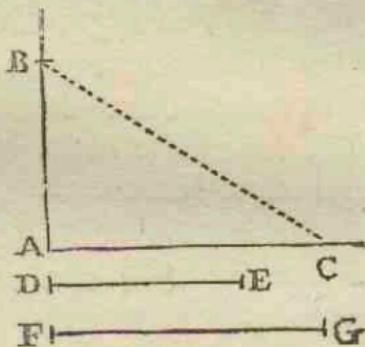
Compas de proportion, dont le centre est A; que le côté DE étant porté sur la Ligne des Plans AB, depuis le centre A en B, ce point B soit le 4<sup>e</sup> Plan; & que l'autre côté FG étant pareillement porté sur l'autre Ligne des Plans AC, depuis le centre A en C, que ce point C soit le 9<sup>e</sup> Plan. Cela étant supposé, le Compas de proportion étant ouvert à angle droit, en sorte que l'angle A soit droit, la distance BC, de 4 à 9, prise
