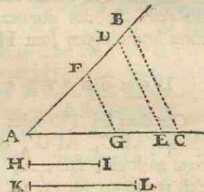
les deux points F, G, soient chacun le point par exemple du 8<sup>e</sup> Solide, auquel on appliquera si l'on veut, la longueur du côté HI, en sorte que la distance FG, de 8 à 8, soit égale à ce côté HI, pour appliquer ensuite sur la même Ligne des Solides la longueur de l'autre côté KL, de part & d'autre de D en E, en sorte que les points D, E, soient chacun également éloignés du centre A, c'est à dire d'un même nombre de Solides, qui soit
