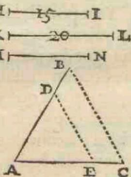
point D, ou E, est 15, par exemple, on marquera 15 sur la ligne HI: & pareillement en portant la longueur de la seconde ligne donnée KL, sur la même Ligne AB ou AC, des parties égales, depuis le centre A, en B, ou en C, on trouve que ce point B ou C, est par exemple 20; on écrira 20 sur la seconde ligne KL. Après cela ouvrez le Compas de proportion, en sorte que la distance DE de 15 à 15, sur la ligne des parties égales, soit égale à la troisième ligne donnée MN; & alors la distance BC, de
