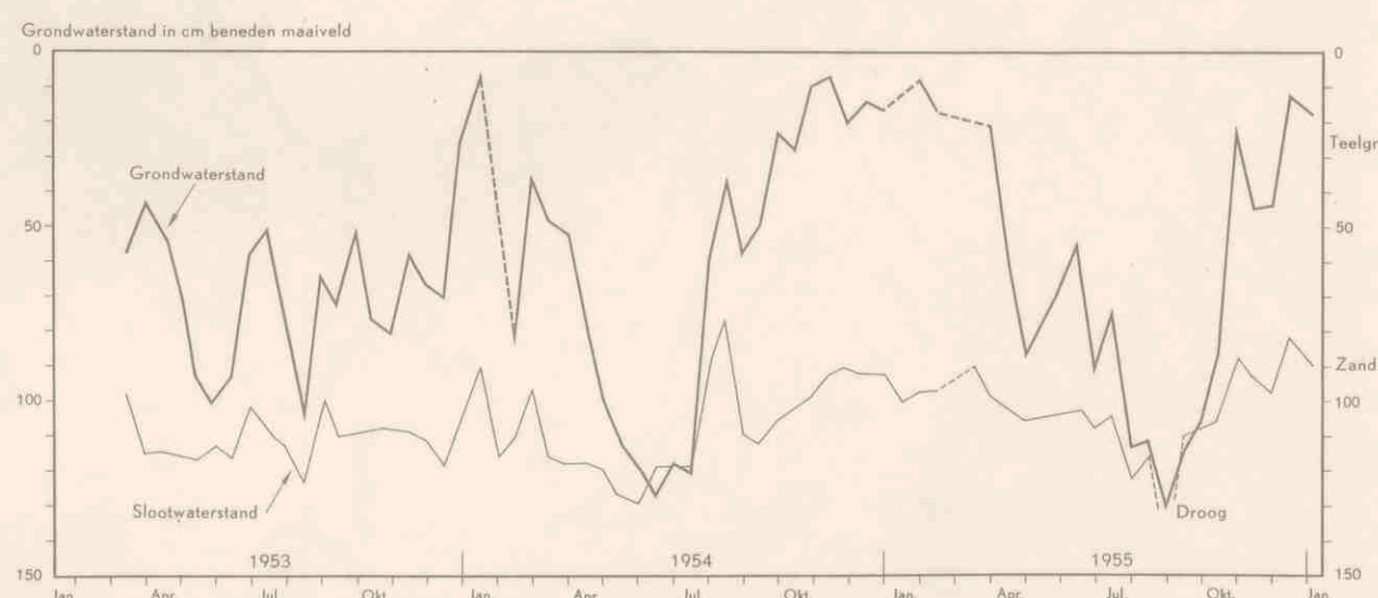
Fig. 2. Zonder toevoer van water aan het slotenstelsel ter compensatie van de droogte in de zomer daalt het grondwaterpeil slechts zelden beneden het slootpeil. Het land verliest het grootste deel van het jaar water door afstroming.
