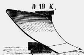
Fig. 94. Ploeglichaam met steil rister voor het ploegen van losser grond, die in vochtigen toestand kleeft, breken de grond meer en geven een breede zuivere voor.
