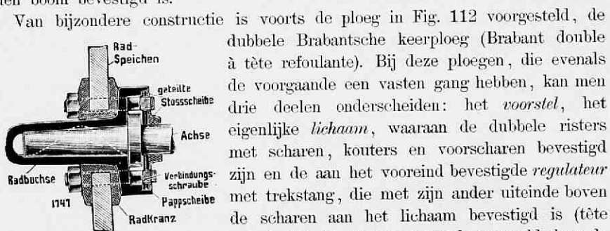
Fig. 110. Inrichting der raderen van Eckert's ploegen. De assen zijn van bussen voorzien, die het indringen van zand en stof beletten.
