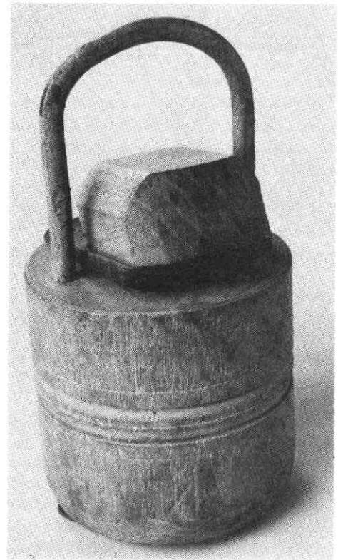
Houten pomphart (zuiger met klep) van Douglas hand-zwengelpomp. Schenking van G. C. Swart te De Meern.
