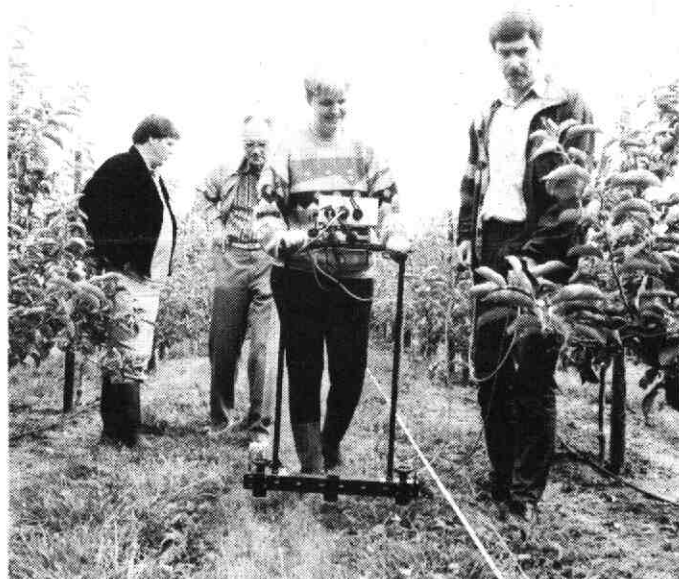
1. Medewerkers van de stichting RAAP voeren weerstandsmetingen uit op het terrein van het badhuis. Op de achtergrond kijkt de oud-voorzitter van de Historische Vereniging, dr D.W. Gravendeel, kritisch toe. (Foto: Demmi Postema)
