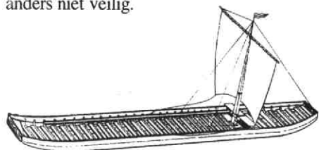
Afb. 14 Reconstructie van een Romeinse plathodem waarvan de restanten zijn opgegraven bij Zwammerdam. Het schip is 4,5 m breed, 34 m lang en 1,2 m hoog en had een laadvermogen van 100 ton. (uit: „Op pad met de Romeinen”).
