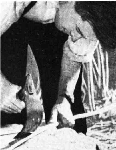
De dissel wordt gebruikt om de stok in tweeën te kloven. Het is een bijl, waarbij het vlakke of holle blad dwars op de steel zit.
