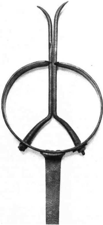
Een schilijzer wordt met krammen aan de paal bevestigd. Ook het maken van krammen was het werk van de smid. Zie de initialen van de maker van het ijzer: het smidsteken.
