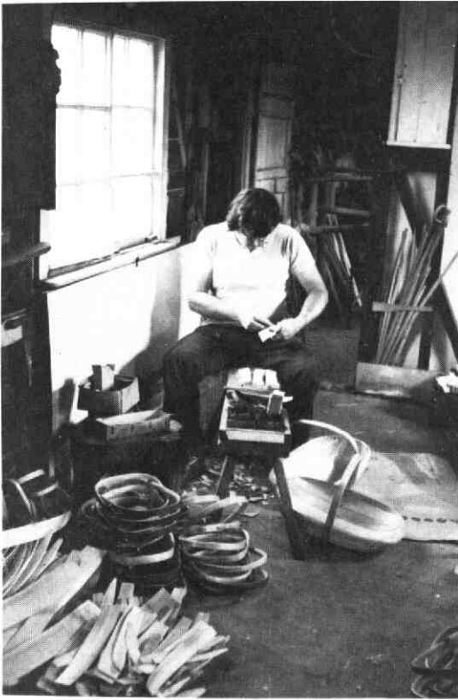
De mandenmaker aan het werk tijdens het vervaardigen van de „trug”. Links op de voorgrond zijn de hoepels en de plankjes duidelijk zichtbaar. Rechts staan twee afgewerkte trugs, nog zonder pootjes, want daar is hij juist aan bezig.
