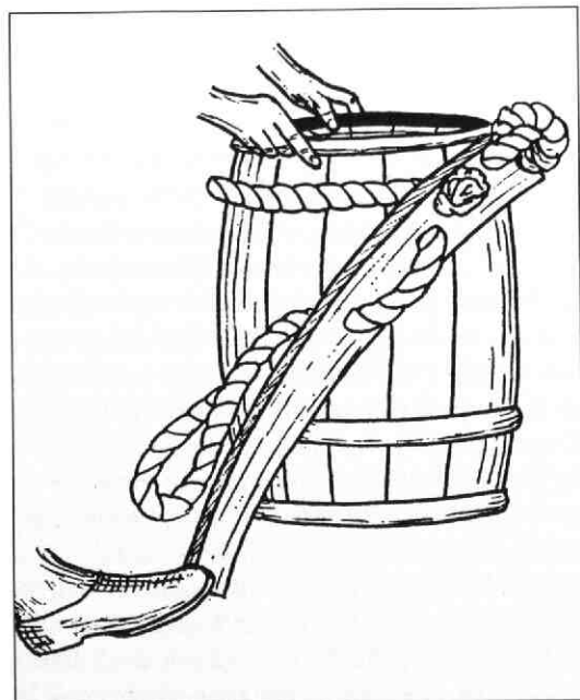
32 Engelse wijze, 'The Dutch hand', om lichtgerende vaten voor droog kuipwerk dicht te krijgen.
