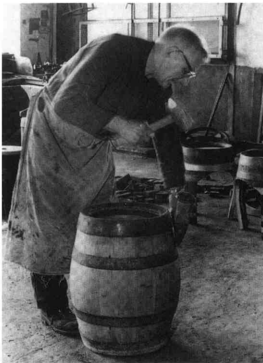
21. Kuiper Verloop, in de typische kuipershouding, drijft met kuipershamer en slagijzer de halsband aan. Het biervat is nagenoeg klaar.
