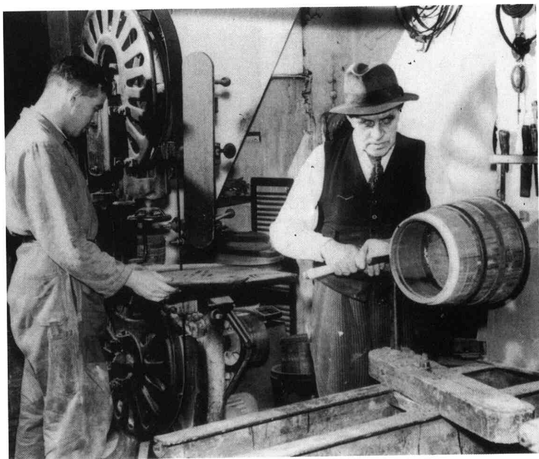
34. Het opzuiveren van de buitenkant van een kuip, welke aan de binnenzijde d.m.v. een stop is gemonteerd op de draaibank. Een vormband is verwijderd; op de achtergrond zien we een lintzaag voor het rond zagen van de bodem.
