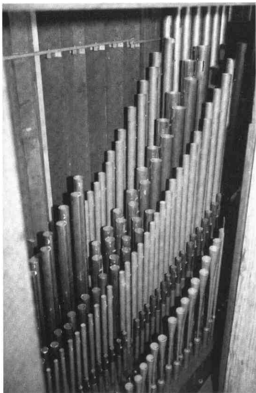
Pijpen van het Crescendowerk: op de rechterfoto met mechaniek voor het openen en sluiten vande Jalousree.
