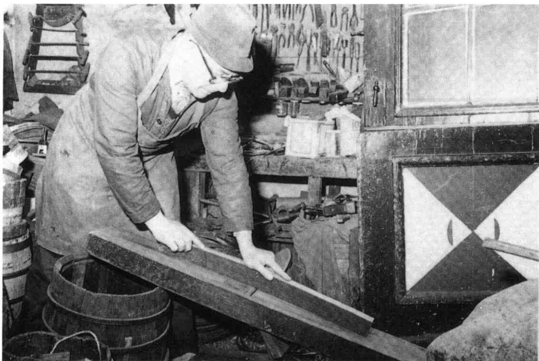
29. Kuiper H. Meester uit Amersfoort bezig met het voegen van een duig.
