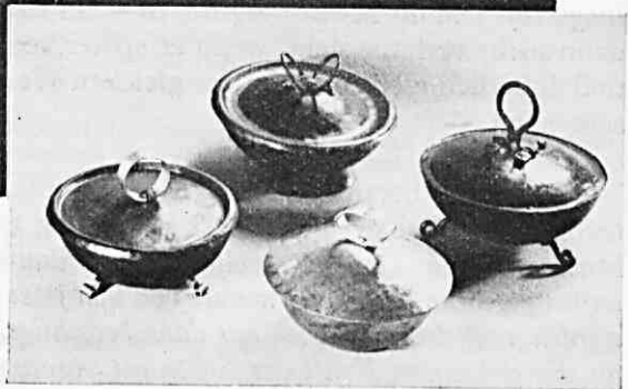
7. Als Abschluß des Treiblehrganges werden hochgezogene Kupfergefäße gearbeitet; am Beginn dieses Schulungsabschnittes werden Schalen aus Schwarzblech geformt.
