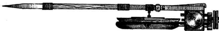
Fig. 77. Trommel met hefboom van kleine afmeting, gemakkelijk naast andere registreertoestellen te plaatsen (op de helft der ware grootte).
