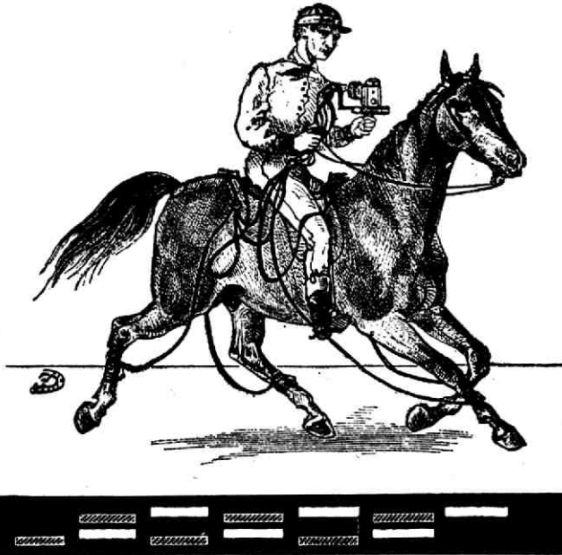
Fig. 86. Paard voorzien van vier voetbekleedingen voor het registreeren van den rythmus van den gang; de ruiter houdt den registreertoestel in de hand.
