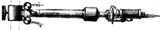
Fig. 78. Elektrische chronograaf van klein model (op de helft der ware grootte).
