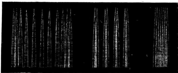
Fig. 252. Beelden van de trillende stift ontstaande bij verplaatsing van een sterk verlichten chronograaf.
