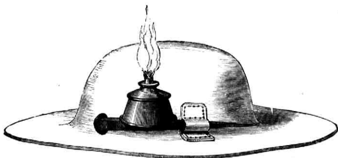
Lamp in de mijnen van Anzin in gebruik. *
