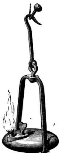
Lamp in de mijnen van Saint-Etienne in gebruik.
