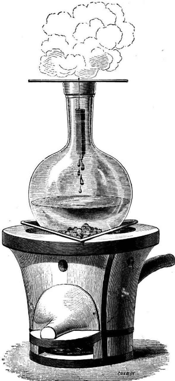
Het smelten van het alloo van D'Arcet.
