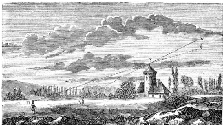
Fig. 34. Schijnbaar hoogteverschil van een voorwerp, naarmate men zich verwijderd of er toe nadert.
