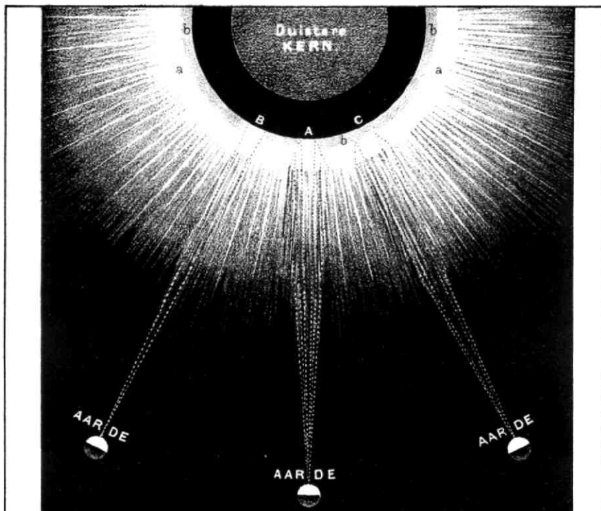
Fig. 1. Uitlegging der zonnevlekken, volgens de hypothese van Wilson. a a de photosfeer; b b b inwendige dampkring; A zonnevlek met kern en halfschaduw; B kern zonder halfschaduw; C halfschaduw zonder kern.
