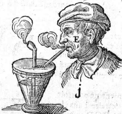
ou bien lorsque le bouchon du siphon 3 est élevé de CC jusqu'à la hauteur DD, l'air voisin est chassé de son lieu sans être beaucoup condensé, & cet air en pousse ensuite un autre; d'où il s'ensuit que de l'air, ou de l'eau, ou de la fumée, ou du lait ou bien quelque autre semblable corps liquide, qui se rencontre dans le voisinage, doit nécessairement
