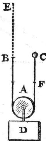
chemin en montant de B vers E, la poulie avec le poids qui y pend, n'est élevée par ce mouvement que depuis A, jusqu'à E, qui ne fait que la hauteur d'un demi-pied; ce qui arrive, à cause que la corde est pliée en deux: Et c'est
