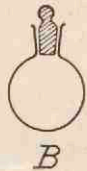
Fig. III. A. Smakula-cuvet met dubbele stop. B. Gewone kwarts-cuvet. Beide op de helft van de ware grootte.
