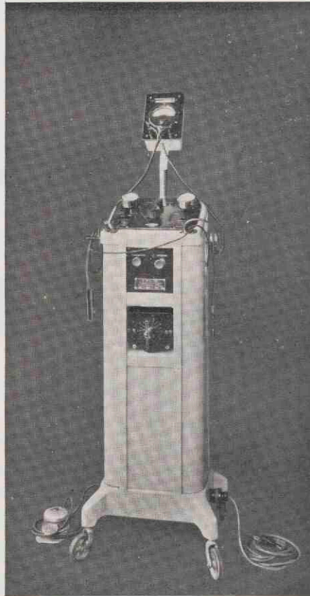
Fig. 3. Diathermie-Apparat „Diatherma“ der Firma A. Walter, Paris, mit aufgesetztem Pyrometer nach Fagouet und Pesme der Firma Toury, Paris. Vorderansicht. Links, Handgriff für die Oberflächenelektrode. Rechts, Handgriff für die Perforationselektrode. Links unten, der Fusskontakt. Rechts unten, der Anschlusskabel.
