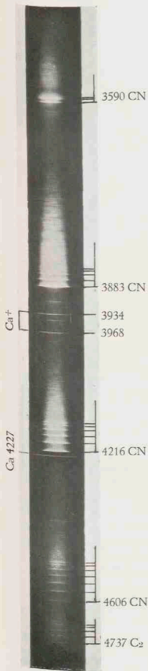
Fig. 4. Spectrum van de lichtboog tusschen homogene koolstaven (golflengten in Å).
