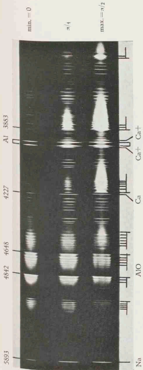
Fig. 11. Wisselstroomboog (50 p/s) tussen koolstofelectroden met Aluminium-poeder.
