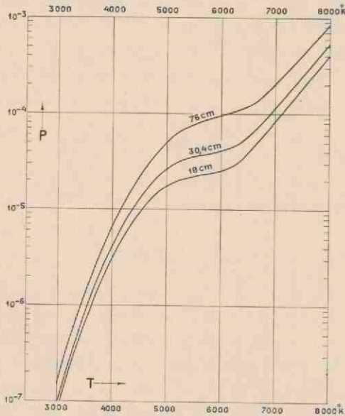
Fig. 36. Thermische ionisatie van een mengsel van twee gassen met V_i = 15 resp. 7 eV en in de mengverhouding 10^4 : 1 , bij drie drukken.
