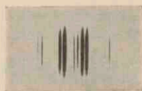
Fig. 10. Echelon-opname van de Li-lijn 6708 Å.
