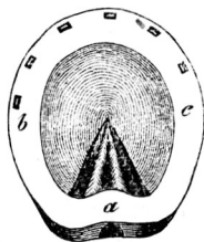
Fig. 14. Ein rundes Eisen in seiner Lage auf einem Vollhufe.
