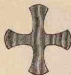
Schroefkalkoen met \dagger -vormige doorsnede volgens Gück.
