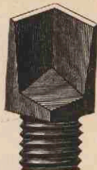
Hoekvormige schroefkalkoen volgens Branscheid en Philippi.
