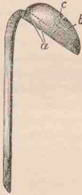
Amerikaansch draversijzer met los toongewicht, van boven en van terzijde gezien.
