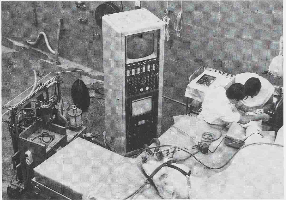
De voor die tijd (1968) luxe monitoring zuil voor de anaesthesie (CO 2 , bloeddruk, ECG en temperatuur).
