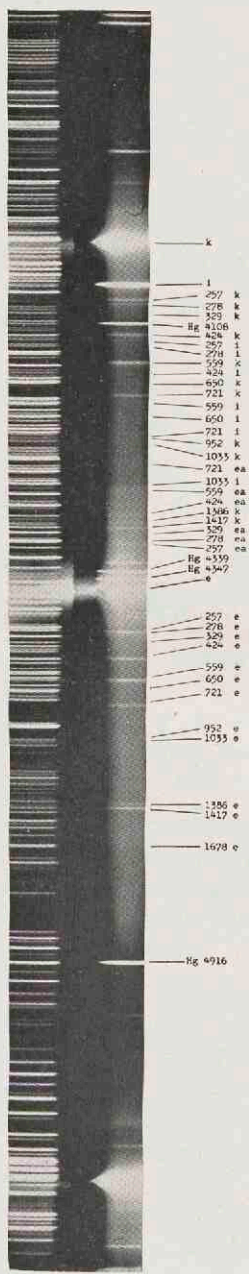
Fig. 15. RAMAN-spectrum van S 1 . Naast het RAMAN-spectrum een Feboog-spectrum, dat voor de uitmeting diende. Bij elke RAMAN-lijn is aangegeven de frequentie in cm -1 en de primaire lijn, waardoor zij is veroorzaakt (notatie KOHLRAUSCH, event. met een letter \alpha = anti-STOKES). De lijnen van het Hg-spectrum zijn aangegeven volgens KOHLRAUSCH of met hun golflengte in A.E.
