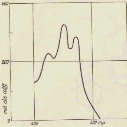
Fig. 15. Absorptiespectrum van \alpha -carotene in hexaan. *)
