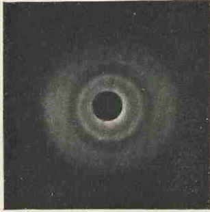
Fig. 19. Röntgenspectrogram van een isotrope nitrocellulosedraad in droge toestand.
