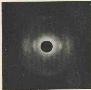
Fig. 20. Röntgenspectrogram van een sterk voorgerekte nitro- cellulosedraad ( v_t = 3,4 ) in droge toestand.
