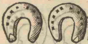
Fers bordez, avec le crampon à l'Arragonnoise, & renforcez sur l'autre quart.
