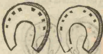
Fers rengrossis par les costez, subtils & tenues par le milieu plus que de l'ordinaire.
