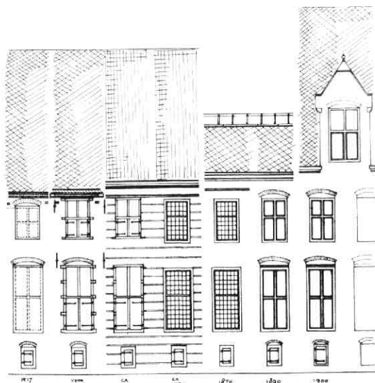
Afb. 51 Janskerkhof 3. Evolutie van de Statenkamer in doorsnede (oostmuur) en gevelaanzicht. Iedere travee vertegenwoordigt een nieuwe fase. Tek. A. F. E. Kipp.
