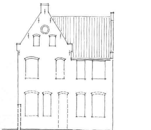
Afb. 83 Jeruzalemstraat 7-9/9A. Reconstructie van de rechter zijgevel van Jeruzalemstraat 7 in de 16e- eeuwse toestand. Tek. C. J. M. Rampart.
