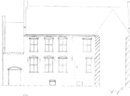
Afb. 92 Jeruzalemstraat 8-10. De korfboog van de door de traptoren ingebouwde vroegere ingang van de zijvleugel, gedeeltelijk verhaakt voor de ruimte in de traptoren.
