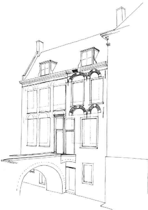
Afb. 124 Kromme Nieuwe Gracht 45. Voorgevel van de huizen Kromme Nieuwe Gracht 45 en 47 met bouwsporen en reconstructie van de oude gevelindeling. Tek. A. F. E. Kipp.
