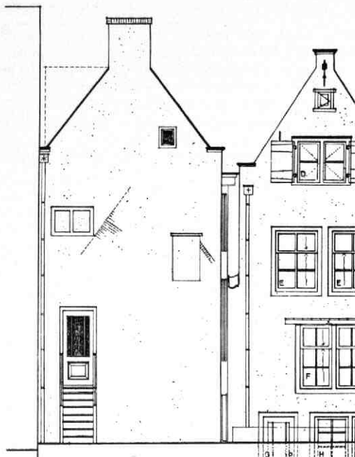
Afb. 243 Springweg 4 en 6. Achtergevel voorste achterhuis van nr 6 na de restauratie van 1986. Tek. Paulus van Vliet arch. BNA Utrecht. Links en rechts zijn sporen te zien van de voorgevel van het bredere tweede achterhuis. Links daarboven is een, niet heropend, bolkozijn aangetroffen, dat hoort bij de verhoging van het voorste achterhuis.
