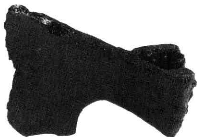
Afb. 39 Geertestraat 14-16. Een timmermansbijl die door timmerman B. Schoenmakers gevonden werd. Deze zogenaamde vlakbijl werd gebruikt om uit boomstammen balken te maken. Restauratie en foto Peter von Hout.
