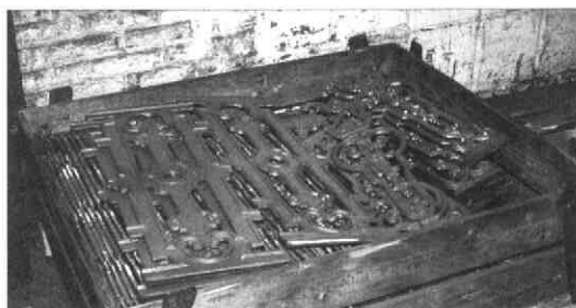
De gegoten en gestraalde hekbalusters
