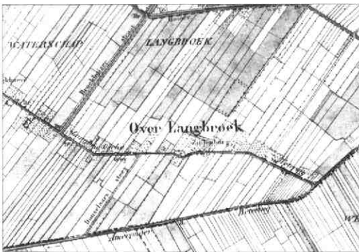
Fragment van een topografische kaart (1:25.000) uit 1918 met de aansluiting van de Langbroekerwetering op de Amerongerwetering (HUA, atlas, 112)
