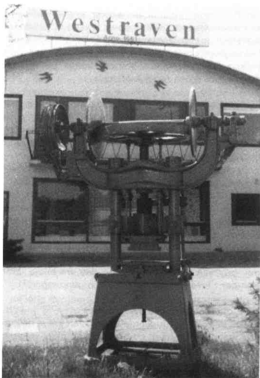
Afb. 1. De frictietegelpers van de Tegelfabriek Westraven staande in Groenekan 1989.
