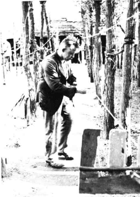
De bomen langs de touwbaan voorkomen uitdrogen van de garens. De krikken zorgen ervoor dat de draden vrij van de grond blijven.
