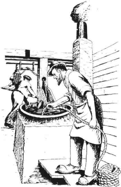
Het teren of tanen van visnetten voor het tegengaan van vochtinwerking.
