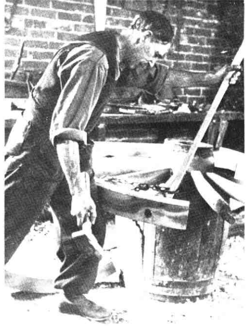
Het slaan van de velgen aan de spaken. De buitenste spaak buigt naar binnen, voor het verkrijgen van de spanning.
